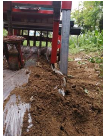
图 8 边膜铲试验过程图
