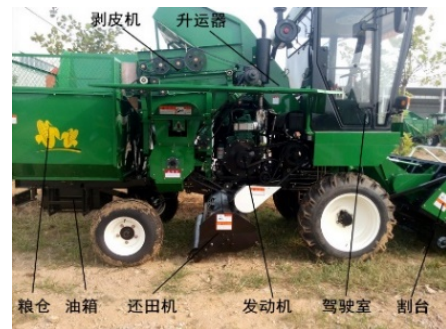
图 9 某款玉米收获机布置结构图
