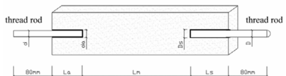
图2 双端植筋拉伸试件
