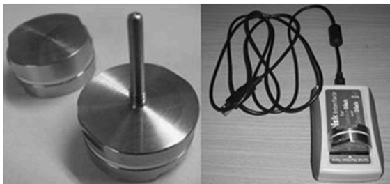
图 2 配有高温探头的电子控制高温数据采集仪
